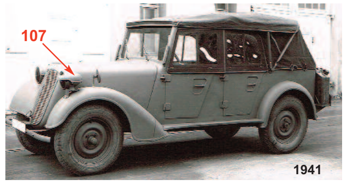
T57k - prototyp , ještě s blatníky T57b, na dalších již lem blatníku hladký. Vpředu tažné háky, užší stupačky než u T57b
