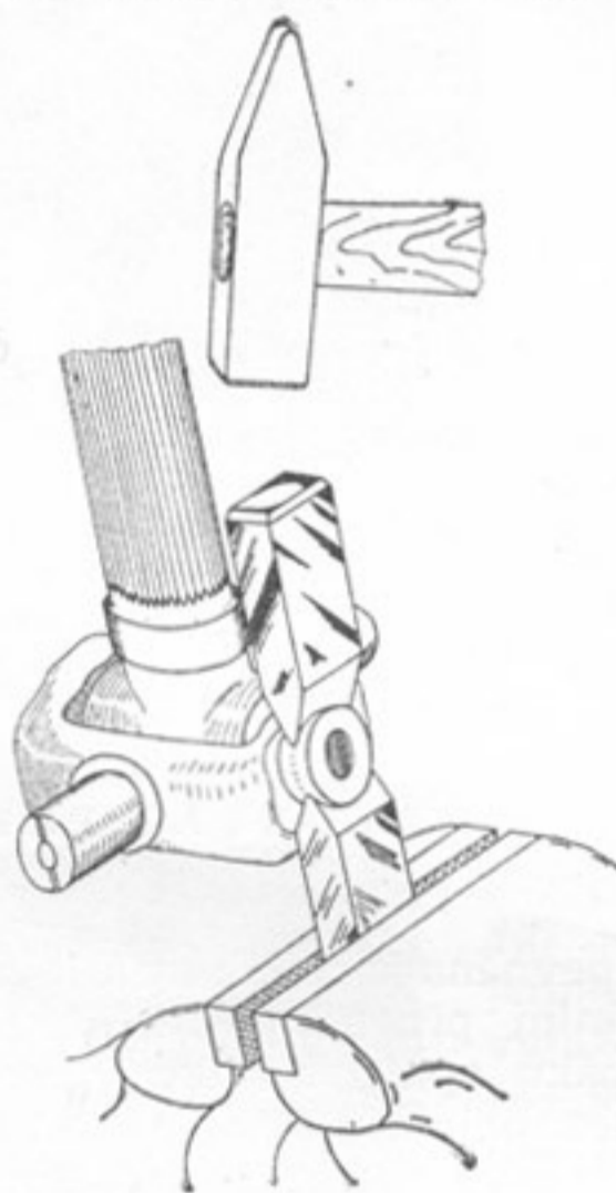
Obr. 88. Pojištění krycího plechu (víčka) zaklepáním okrajů k nákrůžku kříže.
