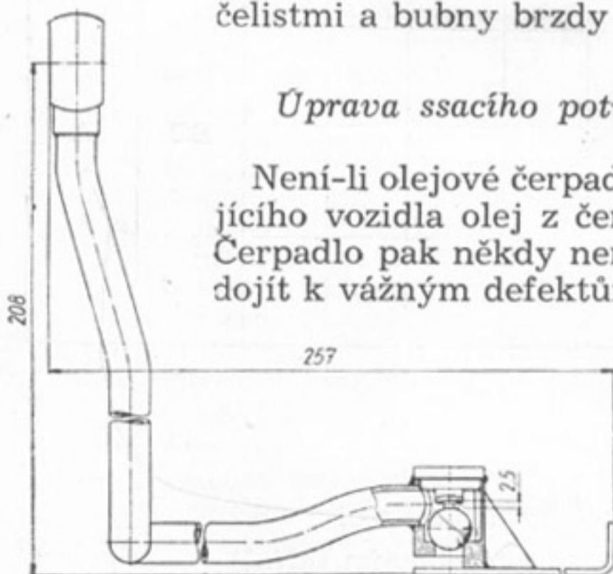
Obr. 125. Ssací trubka č. souč. 805.9.21.55-2 se zpětným ventilem.
