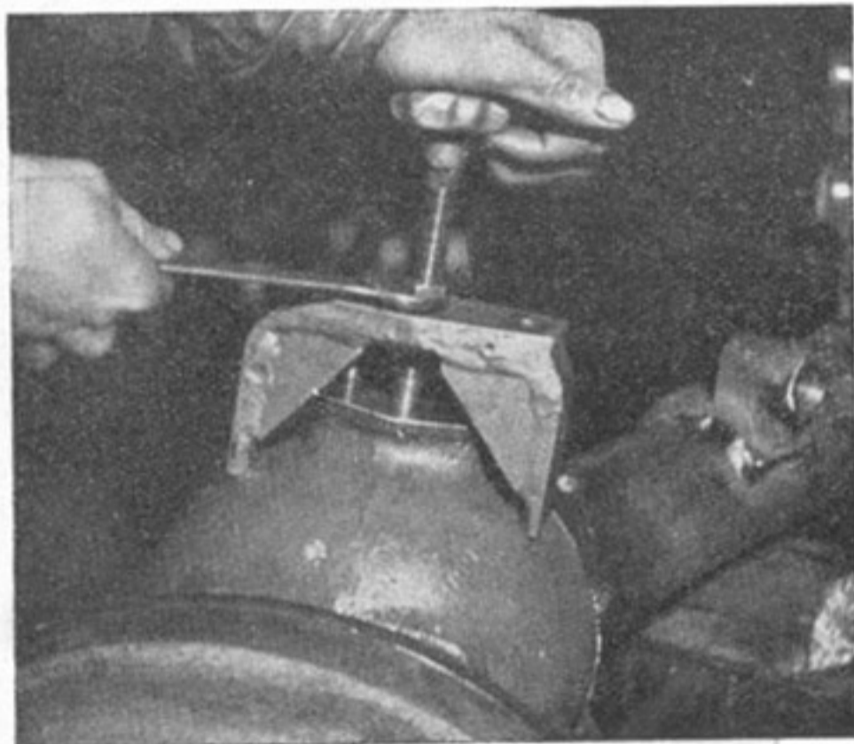
Obr. 85. Vytahování čepu z rozvidleného čepu kola (přípravkem Ab Oca 3215).
