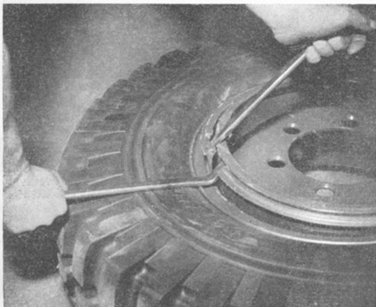
Obr. 111. Nadzdvižení závěrného kruhu ráfku.
