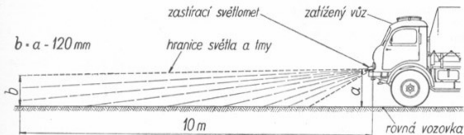
Obr. 122. Seřízení zastíracího světlometu.
