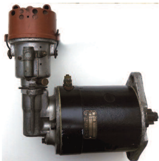
Dynamo a rozdělovač pro Aero 50 model 1938 -1939
