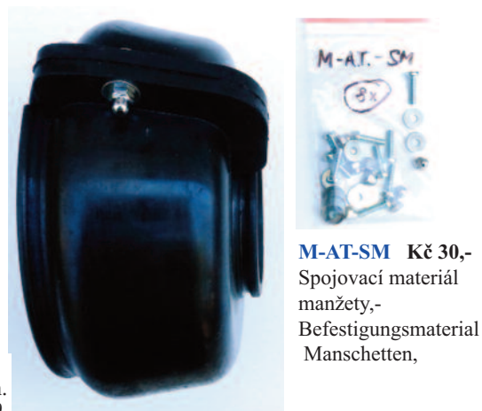
L 3028 -Dělená KČ 640,- * Gumová manžeta náboje 130/60x80 mm AERO 30,50 - Gummimanschette der Vorderradnabe durchm.130/60x80 mm (pro nouzovou rychlou opravu)
