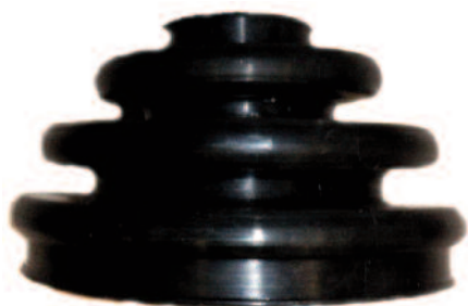
Škoda-399-5439 KČ 660,- * Škoda - manžeta kloubu -nedělená,-prům./durchm. 143/46x90 mm Manschette des Gleitkretzgelenkes,-
