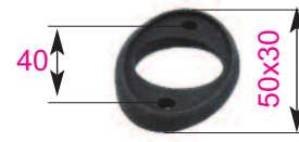
G-KL- T - 2 Náhradní pryž.podl. šikmá pro vyrovnání sklonu dveří,- Ersatz Gummi-Unterlegscheibe- Leaning Tür zu entzerren sklon 8 stupňů,-Steigung 8 Grad
