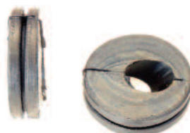
G - L4631 Průchodka přívodu benzínu (v pedálové podlaze),- Dichtungsschaumgummi um den Benzinschlauch (30/13 x 9 mm)
