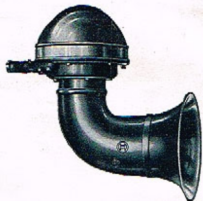
Obr. 44 Houkačka se zahnutým zvukovodem
