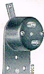
Obr. 29 Vypínač světla Stop
