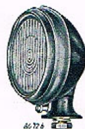
Obr. 33 Postranní svítilna L75 pro upevnění na blatník
