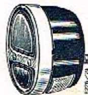
Obr. 33. Výstražná svítilna Q 80 se zadním světlem
