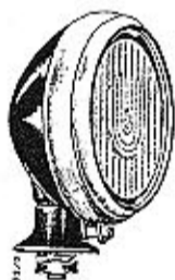
Bild 14 Seitenlaterne L 75 zur Befestigung auf Kotflügel
