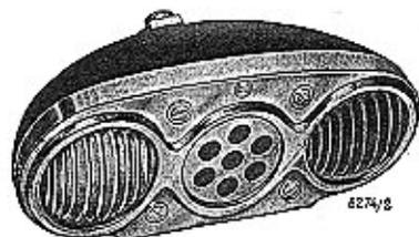
Bild 31 Brems-Schluß-Rückfahrlaterne
