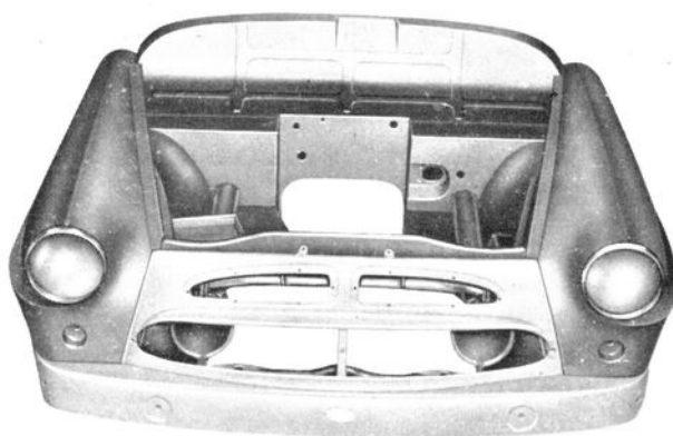
Obr. 5. Úplný přední díl karosérie (s namontovaným úplným spodním dílem masky chladiče a maskou).
