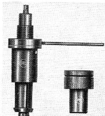
Abb. No. 15. Abzieher FN 3318 (ev. 3322), Lagersetzstock FU 4309 (ev. 4393)
