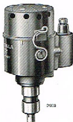
Obr. 7. Rozdělovač typu BN4 s horizontálními kabelovými vývody. Cívka viz obr. 9.
