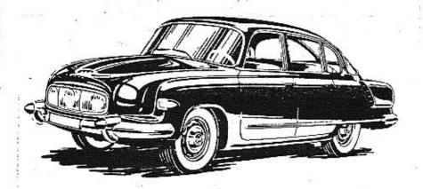
Osobní automobil se vzduchem chlazeným vzadu umístěným motorem — 8 válců — vrtání 75 mm — obsah 2472 ccm (nebo 2545 ccm) — výkon 95 HP — nejvyšší rychlost 160 km/h — 6 sedadel.
