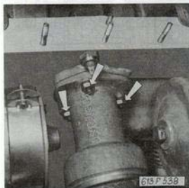
Obr. 05-4 Upevňovací matice praveho víka
