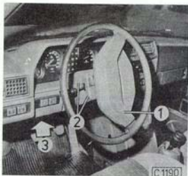
Obr. 08-10 Demontáž volantu
