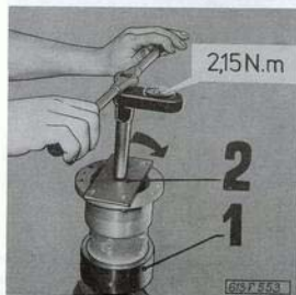
Obr. 05-19 Ustavení předpětí ložisek pomocí přípravku MRP-0100
