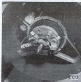
Obr. 13-7 Seřizování mezery mezi kontakty
