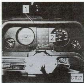
Obr. 14-21 Šrouby uchycení panelu přístrojů
