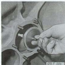
Obr. 06-23 Montáž rozpěrky
