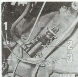
Obr. 02-118 Přední závěsné šrouby motoru
