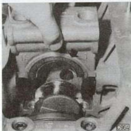
Obr. 02-58 Montáž vodícího ložiska s axiálními kroužky
