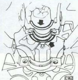
Obr. 02-56 Montáž horních axiálních kroužků
