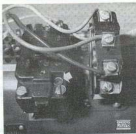
Obr. 13-14 Seřizovací šroub na termospínaci
