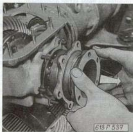
Obr. 05-3 Vyjmutí hřídele s víkem
