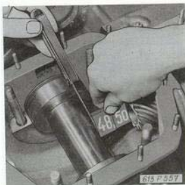
Obr. 05-23 Měření skutečného rozdílu
