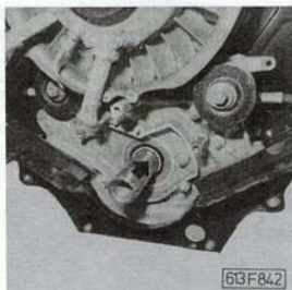
Obr. 02-100 Montáž kroužku hřídelového těsnění
