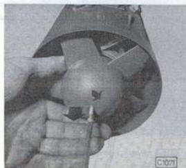
Obr. 13-5 Stahování axiálního kola elektromotoru
