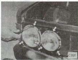
Obr. 14-17 Upevňovací šrouby světlometů
