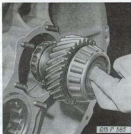
Obr. 06-24 Montáž hnacího kola
