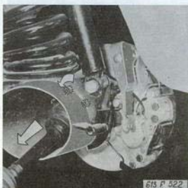
Obr. 07-3 Uvolnění hnacího hřídele u kolové části
