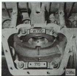
Obr. 05-30 Montáž vík diferenciálu
