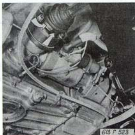
Obr. 09-1 Odpojení hnacího hřídele
