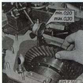
Obr. 05-32 Měření zubové vůle
