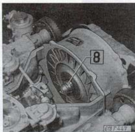
Obr. 02-18 Demontáž kapalinové spojky
