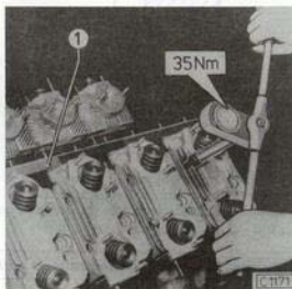
Obr. 02-81 Montáž hlav na válce
