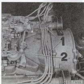
Obr. 02-16 Demontáž kapalinové spojky
