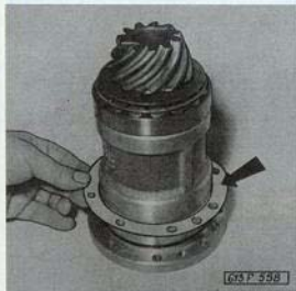
Obr. 05-24 Nasazení vymezovací podložky
