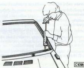
Obr. 15-5 Utěsnění čelního okna
