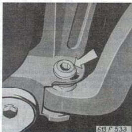
Obr. 08-22 Excentr vnějšího závěsu suvného ramene
