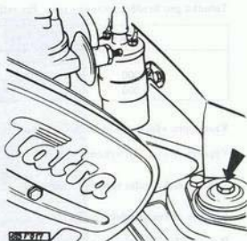
Obr. 02-117 Zadní závěsné šrouby motoru
