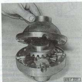
Obr. 05-17 Sestavení skříňné diferenciálu
