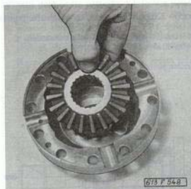
Obr. 05-14 Nasazení planetového kola
