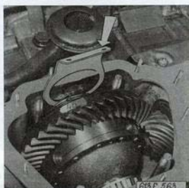
Obr. 05-29 Nasazení vymezovací podložky
