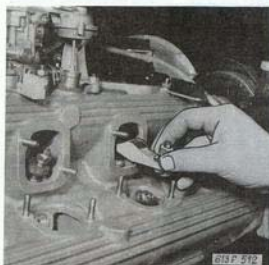
Obr. 02-113 Montáž vahadel ventilů
