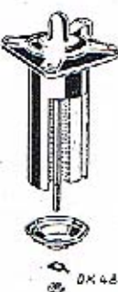
Abb. 19. Entnahme und Ausbau der Ölfiltereinlage.
