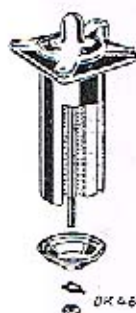
Obr. 19. Vyjmutí a demontáž vložky čističe oleje.
